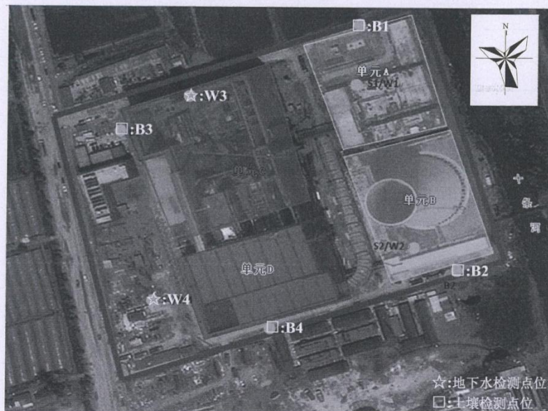
台州旺能再生资源利用有限公司三期土壤和地下水自行检测点位示意图
